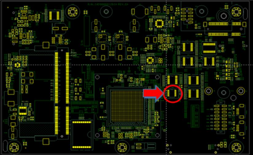
**X86 Rangeley CPU Module thermal sensor**
